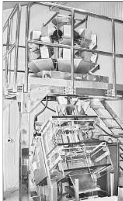
Die gefrorenen Teigtaschen werden über ein Steigband vom Froster zur Waage gefördert. Auf der Computerkombinationswaage wird das Produkt verwogen und über eine Rutsche in die Schlauchbeutelmaschine abgeworfen
